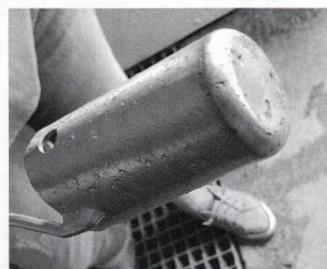
一般に使用される生乳のサンプリング用機材。経年の使用によって、傷などからサンプルのコンタミネーション(試料汚染)を引き起こす可能性もある
